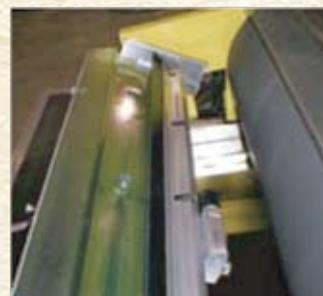
彩色精印(ColorMaster)单刀系统是一种针对双辊轮印刷部的经济型升级设备。它包括涂墨部、支撑柱、固定托架，这些装置用来支持网纹辊和无需工具的换刀功能。可选组件包括一个电动控制的抽液系统、清洗系统和带有触摸屏界面的PLC控制器。
